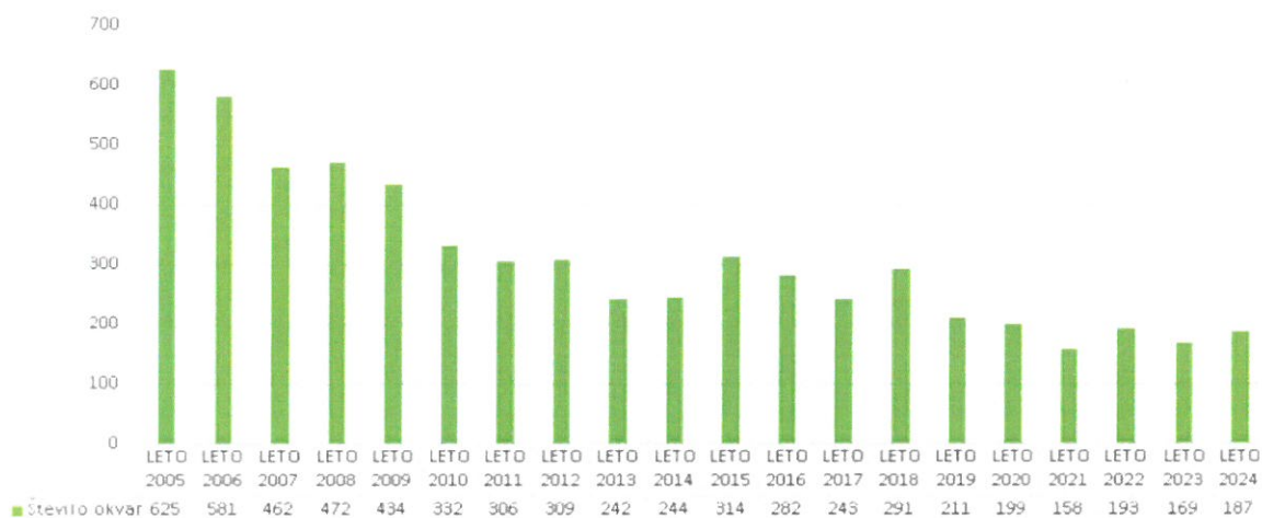
Slika 23: Grafični prikaz števila okvar na javnih vodovodnih sistemih po letih (2005–2024)
