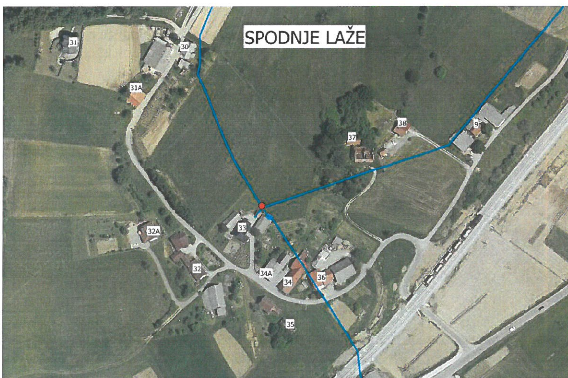
Slika 19: Vodovodni sistem Spodnje Laže - Hidrantno omrežje
